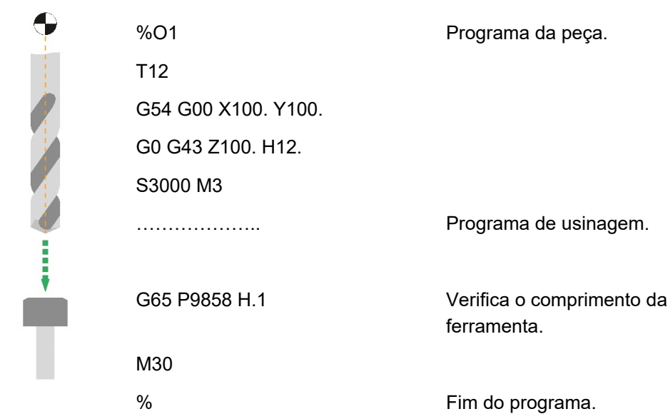
Figura 6.2 Verificação de uma broca
